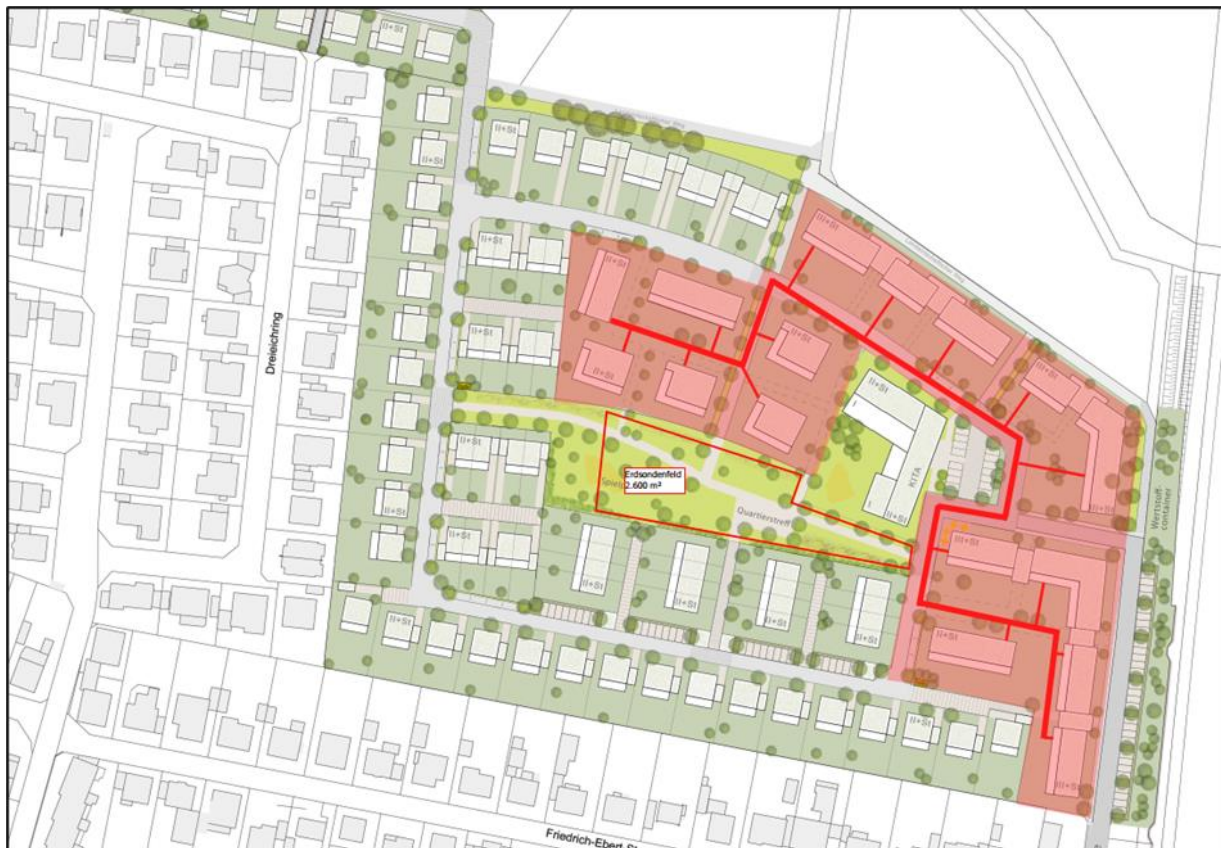
Abbildung 4.4: Kaltes Nahwärmenetz mit Erdsondenfeld für Mehrfamilienhäuser (energielenker GmbH 2020)
